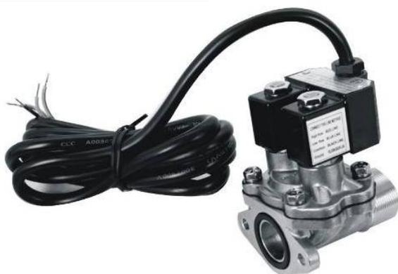
Клапан соленоидный предназначен для управления потоком топлива, обеспечивая снижение расхода топлива перед окончанием выдачи дозы и прекращение подачи топлива после выдачи заданной дозы. Соленоидный клапан имеет три состояния: закрыт, открыт на малый поток, открыт на большой поток. Управление состоянием клапана осуществляется путём подачи и снятия питающего напряжения.
