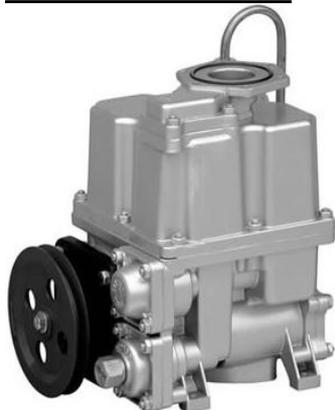
Моноблок представляет собой комплексный агрегат, в котором соединены функции всасывающе-нагнетательного насоса и газоотделителя. В верхней части моноблока располагается выход, к которому подключается измеритель объёма топлива.
